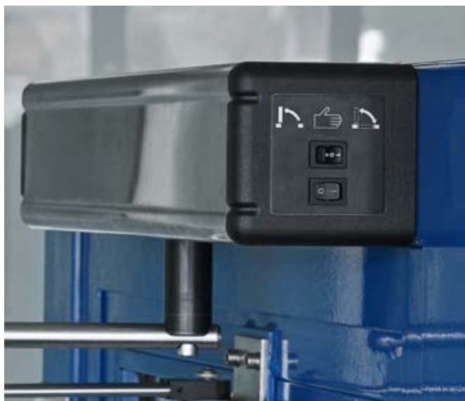
Im FDC integrierter Programmschalter «Automat-Hand-Offen».
